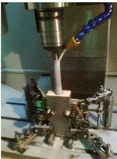
Рис. 15.14. Растачивание отверстия на СЧПУ
