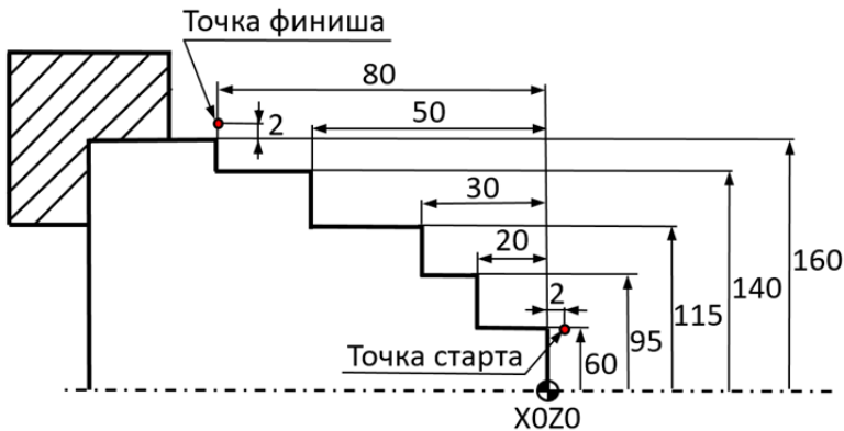
Рис. 9.4. Профиль детали для токарной обработки
